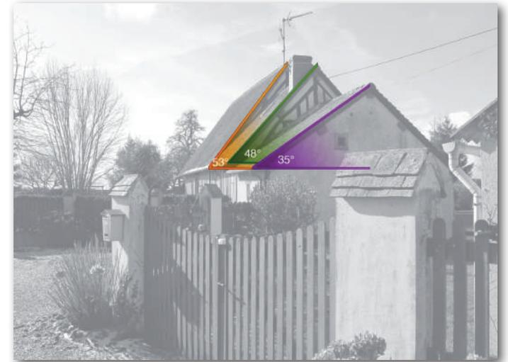
Figure 49 / Traditionnellement, les faîtages des annexes se situent dans le prolongement des faîtages du bâtiment principal et les pentes des bâtiments principaux varient autour de 50°.
