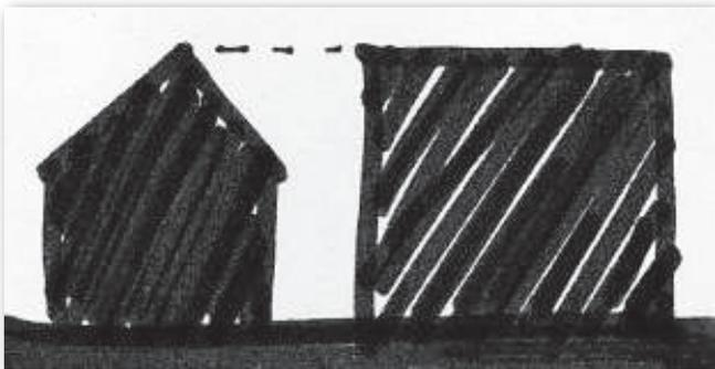
Figure 6 / La hauteur des constructions est mesurée à partir du point le plus bas du terrain naturel initial au droit de la construction jusqu'au faîtiage.
