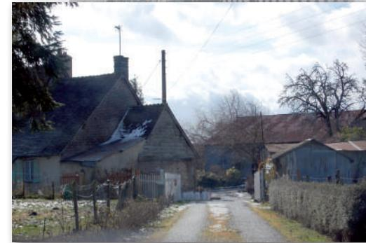
Figure 11 / Traditionnellement, les faîtages des annexes se situent dans le prolongement des faîtages du bâtiment principal et les pentes des bâtiments principaux varient autour de 50°.
